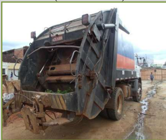
Figura 35 - Compactador de lixo (Santa Filomena)
