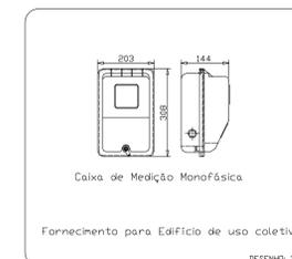
Caixa medidor monofásica - Plástica Padronizada
